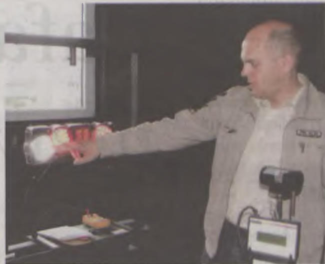
- Mamy własne laboratorium, w którym wszechstronnie testujemy nowo projektowane wyroby. Badamy np. luksomierzem natężenie światła, fotometrem - jego zasięg, a kolorymetrem - jakość barw - pokazuje na fot. Leszek Waś
