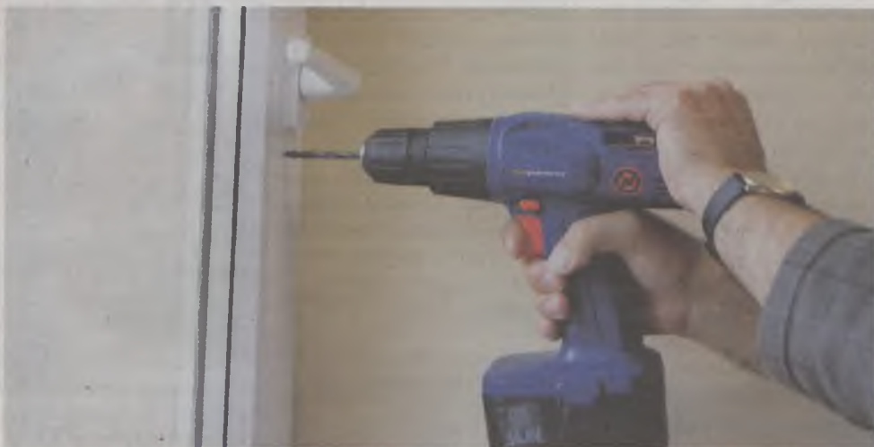
Wchodzą poprzez precyzyjne wkręcenie się wiertłem do zamka plastikowych drzwi lub okien
