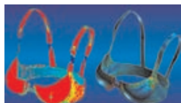
Rys.2 Ilustracja rozkładu naprężeń zredukowanych w wyjściowym prototypie biustonosza oraz w jednym ze zmodyfikowanych modeli
