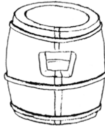
Ryc. 10. Korpus zaworu ssącego (II 2)
