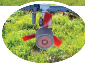
Urządzenie do wytwarzania mgły, podwieszone pod skrzydłami samolotu
