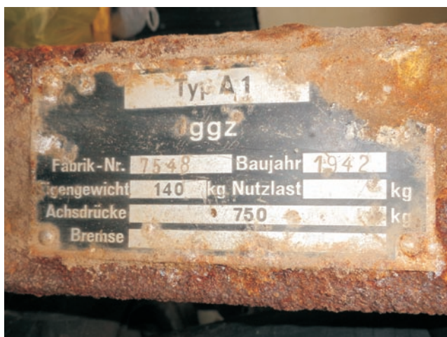
Tabliczka znamionowa z marcinkowickiej przyczepki, data produkcji, numer seryjny, waga, ładowność
