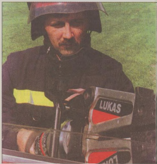
Ogniomistrz Dariusz Pasek otwiera za pomocą rozpieracza hydraulicznego uszkodzony samochód
