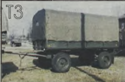
T3 Przyczepa towarowa D-44A Ładowność 3000 kg, pojemność skrzyni ładunkowej - 3,85 m, masa własna 1550 kg, wymiary skrzyni ładunkowej (długość x szerokość x wysokość) - 3760 x 1909 x 500 mm, drewniana, maks. prędkość holowania 50 km/h, hamulec główny pneumatyczny, pomocniczy mechaniczny, rozmiar ogumienia 7.50 - 20". Oława, tel. 0999-99-99-99
