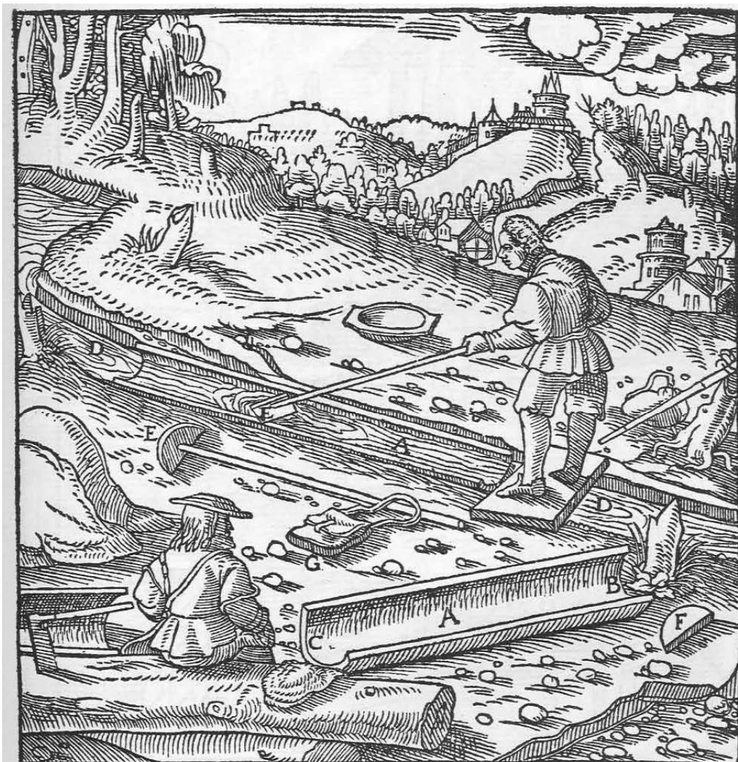
Der Trog A. Sein offenes Ende B. Sein geschlossenes Ende C. Der Bach D. Die Kiste E. Das Brettchen F. Die lederne Tasche G.
