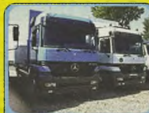
MERCEDES 1835 ACTROS GLOBETROTTER 1998 r. Euro II, Pakiet L, 350 KM, 2 osie, zawieszenie pneumatyczne, ABS, ASR, webasto, tempomat, kabina sypialna, typ komfort, ład. 7 t. P7160454
