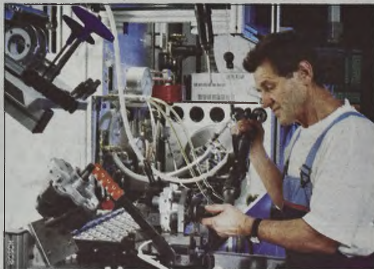
Testy wysokociśnieniowej pompy wtryskowej w zakładzie Boscha w Jihlavie (Czechy)
