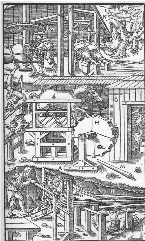
Die zuerst beschriebene Maschine A. Der Arbeiter, der durch Treten die Bälge zusammendrückt B. Die Bälge ohne Mundstücke C. Die Öffnung, durch welche die schweren Wetter oder die Luft ausgestoßen werden D. Die Latten E. Der Stollen F. Die zweite beschriebene Maschine G. Die hölzerne Trommel H. Ihre Stufen I. Die Umfassung K. Das runde Loch in der Trommel L. Die Stange M. Die dritte beschriebene Maschine N. Die stehende Welle O. Ihr Zahnrad P. Die liegende Welle Q. Ihr Getriebe R.
