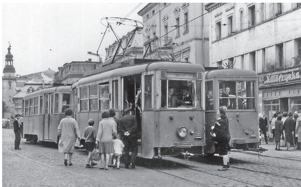
Ryc. 8. Tramwaje 5N+5ND na mijance na Placu Piastowskim. Widać tył przyczepy 5ND składu w przeciwnym kierunku
