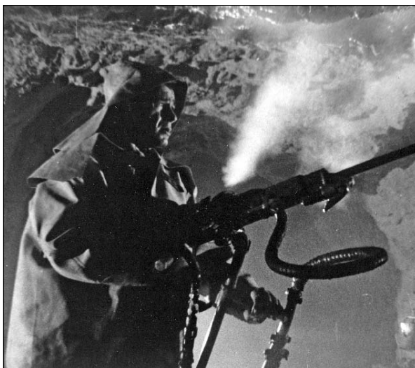
Górnik z urządzeniem wiertniczym przystosowanym do wiercenia z przeplódką wodną w kopalni w Radoniowie (1)
