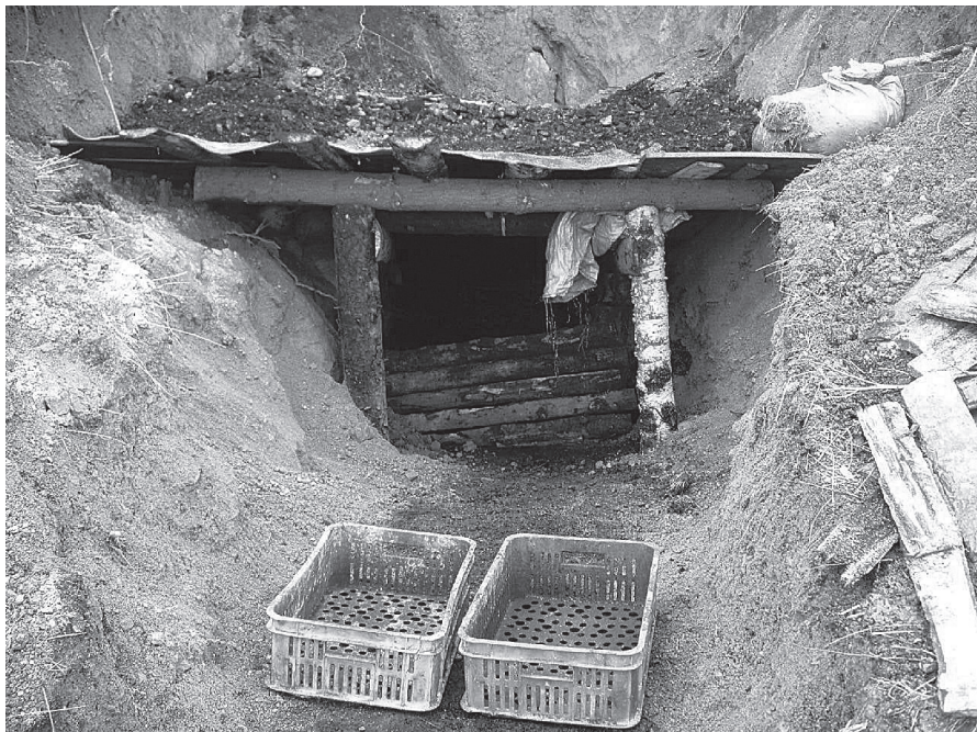
Fotografia 1. Wejście do biedaszybu
