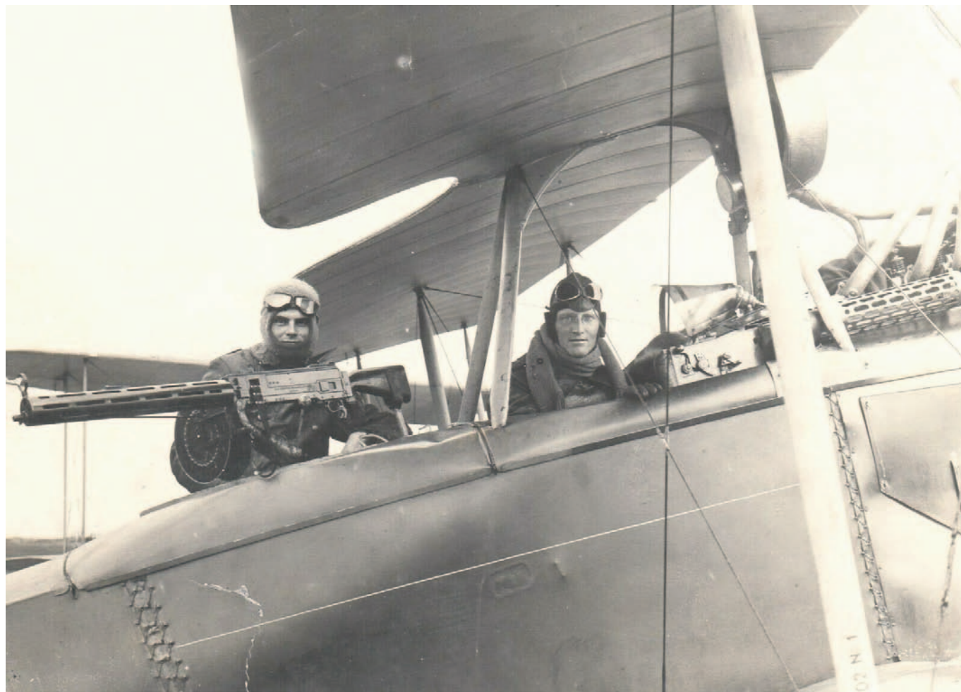
Rumpler i lotnicy. To wprawdzie inna załoga, ale z tego samego okresu. Fotografia archiwalna dobrze ilustruje, jak wyglądał z bliska taki samolot. Warto zwrócić uwagę na widoczne sznurowane płócienne pokrycie kadłuba, łatwo zdejmowane w czasie bieżącej obsługi maszyny
