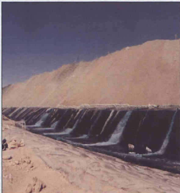
Fot. Proces Biolugowania na haldzie.
