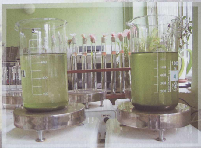
Biomasa mikroglonów zagęszczona z wykorzystaniem koagulantów nieorganicznych z grupy PAX
