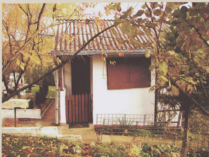
Fot.2. Azbestowe pokrycia dachowe- częsty widok na Dolnym Śląsku
