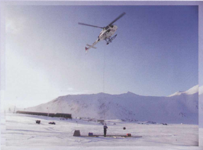
Pomiary struktury i miąższości lodowców z wykorzystaniem radaru podwieszono do helikoptera
