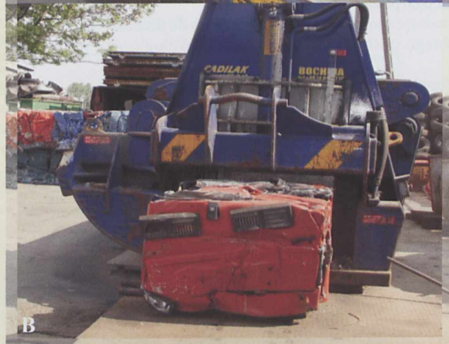
Zgniatarka do karoserii pojazdów (A) i pojazd po zgnieceniu (B)
