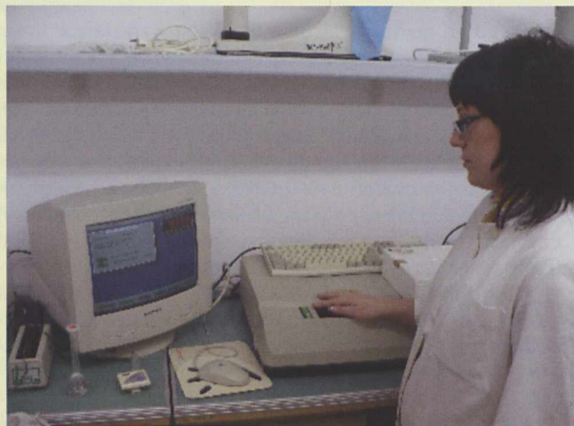
Przygotowanie prób i pomiar spektrofotometryczny zawartości azotanów w warzywach
