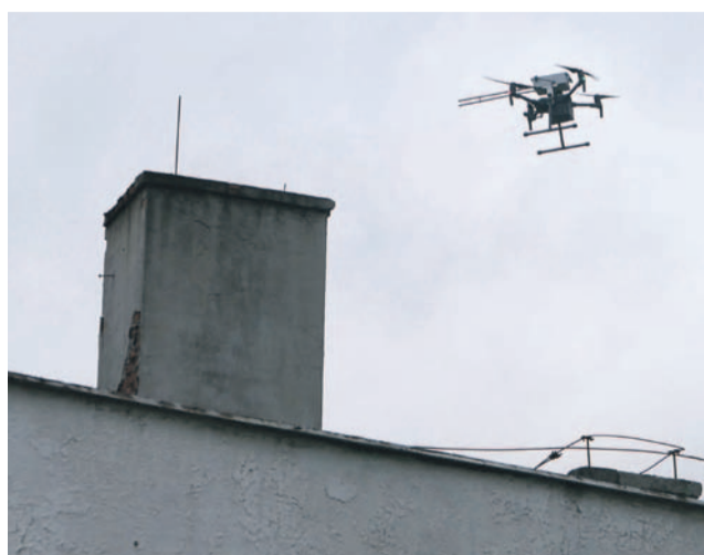
Dron wyposażony jest w stację analizy powietrza i w ciągu kilku sekund wykazuje skład spalin wydobywających się z kominą
