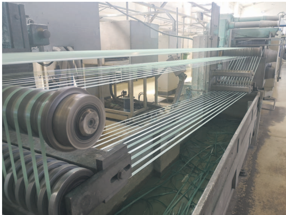
Maszyna odpowiednio kształtuje taśmę, jej grubość i szerokość
