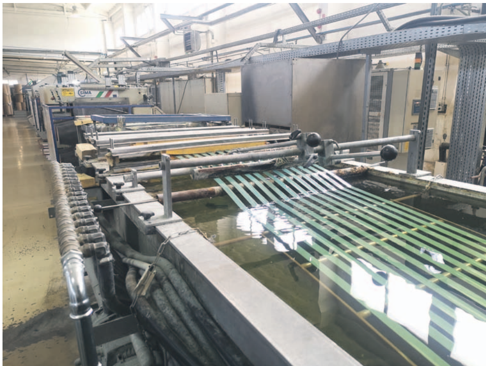
Gorąca taśma, po schłodzeniu, najpierw jest dość szeroka, ale potem ulega odpowiedniemu rozciągnięciu i zwężeniu
