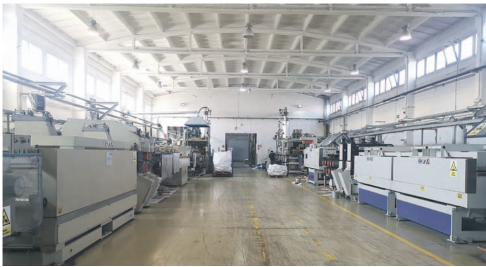
W tej hali rozdrobione butelki PET w postaci granulatu przeradzają się w taśmę PET
