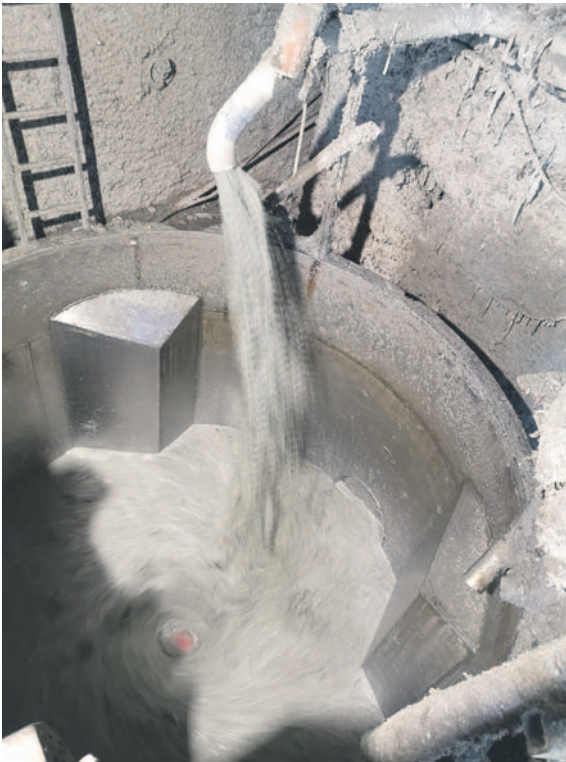
Hydropulper, czyli rozdrabnianie makulatury z użyciem wody
