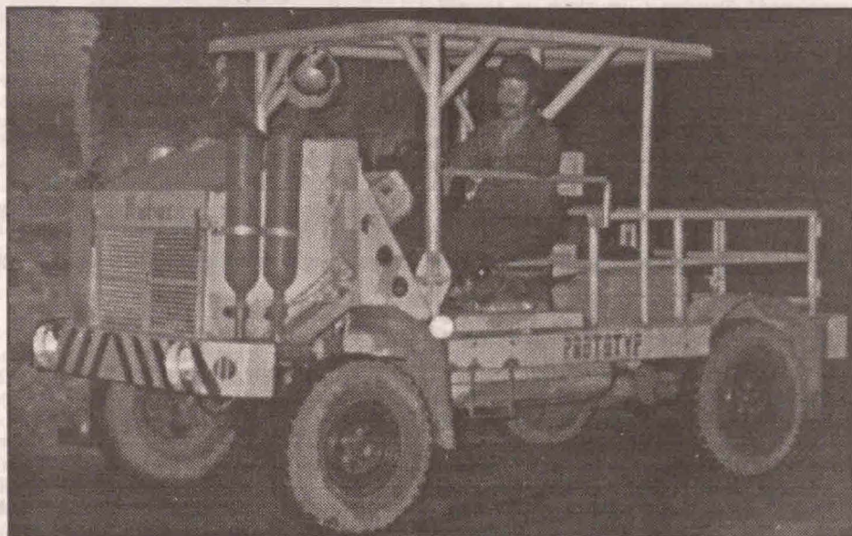
„Kubus” - silnik Perkinsa 3-cylindrowy, zawieszenie sztywne, konstrukcja rurowo-ramowa, oficjalna nazwa: samojezdny wóz transportowy małej mocy
