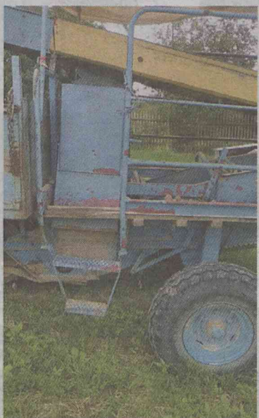
Uszkodzone stopnie wejścia na kombajn do zbioru ziemniaków
