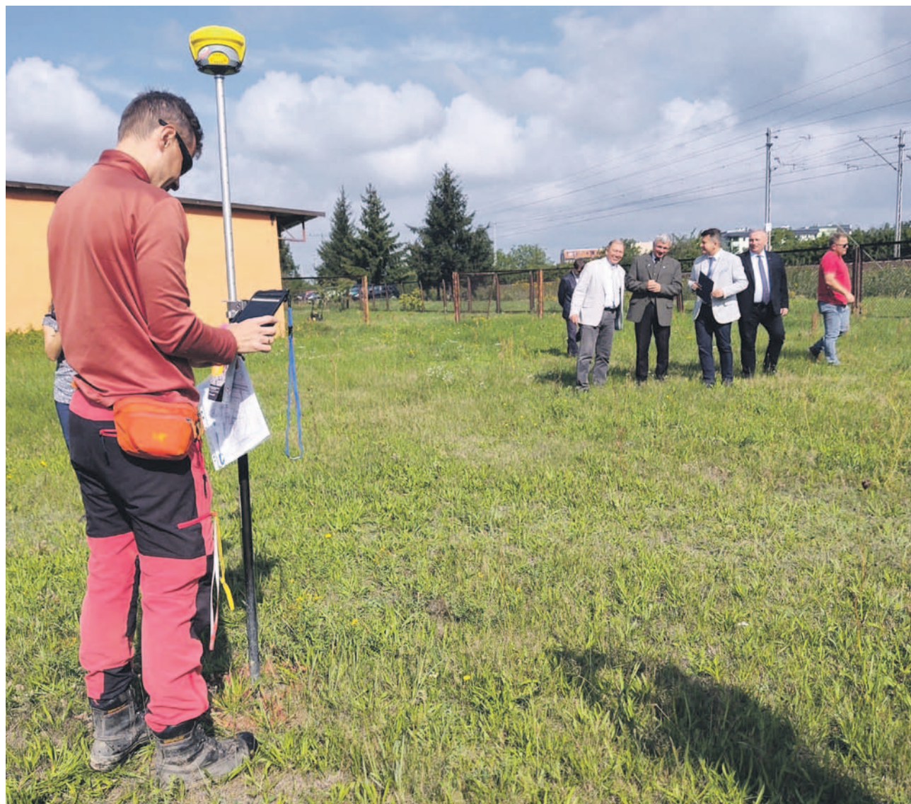
Tego samego dnia geodeta wyznaczył miejsce odwiertu na terenie Miejskiego Zakładu Energetyki Ciepłej w Oławie
