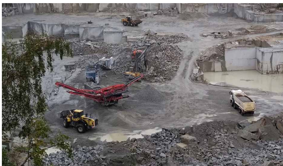
Kamieniołom Żółkiewka, maszyny mielące i segregujące granitowy gruz
