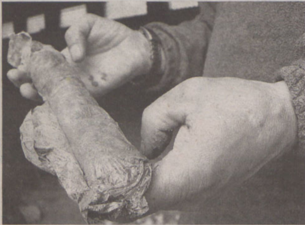
Przebitka z gliny, która uszczelnia otwory strzałowe
